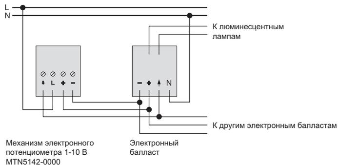
Механизм электронного потенциометра в комбинации с электронными балластами и контактором
