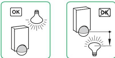
Если включаемые лампы монтируются в зоне охвата Argus, то между лампами и датчиком должно выдерживаться достаточно расстояние. При высокой присоединенной нагрузке это расстояние может достигать 5 м. Если нет возможности выдержать это расстояние, то датчик Argus следует закрыть в направлении лампы прилагемыми закрывающими сегментами.
