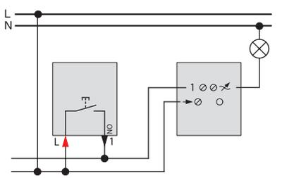
Кнопочный выключатель      Суперсветорегулятор в качестве основного устройства
