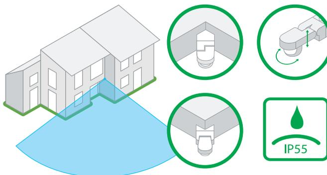
Установка на внутренний и внешний угол, на горизонтальную и вертикальную поверхность (аксессуары в комплекте).
