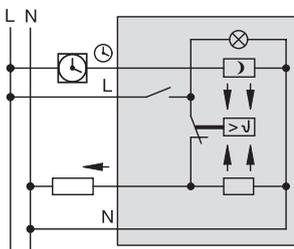
Механизм терморегулятора с переключающим контактом MTN5364..
