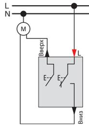
Кнопочный выключатель для рольставней, 1-полюсный
