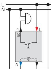
Кнопочный выключатель с замыкающим контактом и отдельным сигнальным контактом MTN3154-0000
