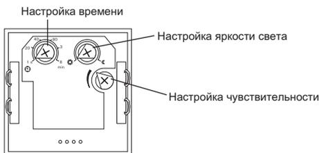
**Механизм электронного выключателя и механизм релейного выключателя** Возможно параллельное включение максимум двух датчиков Argus с механизмом электронного выключателя и максимум четырех датчиков Argus с механизмом релейного выключателя.
