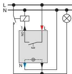
Кнопочный выключатель с замыкающим контактом и отдельным сигнальным контактом MTN3154-0000
