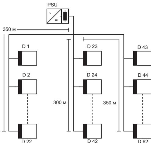
Устройства KNX параллельно подключаются к красному и черному проводам шины через шинные клеммники, к каждому из которых может быть подключено до четырех кабельных пар (красный и черный провод). Шинный клеммник (MTN689701) может использоваться в качестве соединительного терминала в соединительных коробках выключателей. Обязательно соблюдайте полярность подключения проводов!
