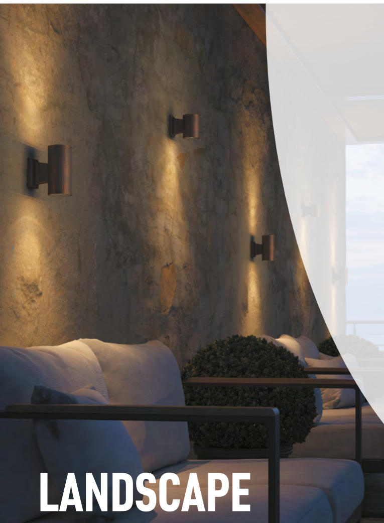
370357 370406 IP 54 Светильник ландшафтный Корпус – алюминий/ рассеиватель – стекло GU10 max 50 Вт 220-240 В Диапазон раб. тем-р от -20° до +40° С
