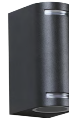
370839 NEW IP 54 Светильник ландшафтный светодиодный Корпус – алюминий/ рассеиватель – закаленное стекло GU10 max 2*15 Вт LED 220 В Диапазон раб. тем-р от -20° до +50° С
