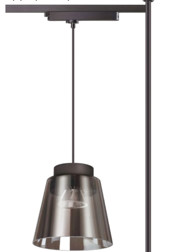
358641 IP 20 ⚡ Светильник однофазный трековый светодиодный Длина провода 1 м Корпус алюминий/ плафон стекло/ рефлектор японский акрил 24 Вт 175-245 В 1800 Лм 4000 К Цвет LED белый Угол рассеивания 38°
